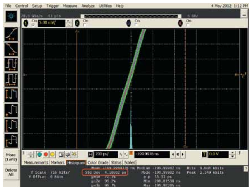
Рис. 3. Измерение джиттера сигнала, созданного по Trueform
